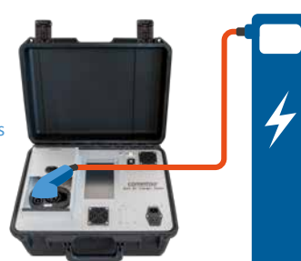
DC-CCS EVSE test setup:
